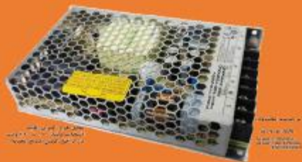
یک نمونه منبع تغذیه سوئیچینگ
